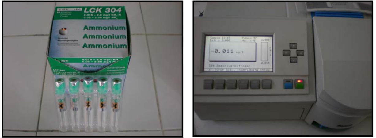
Şekil 13. Amonyak azotu tayininde kullanılan cihazlar (LANGE LCK 304 marka kiti ve spektrofotometre)
